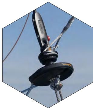
Le KTS (Karver Tack Swivel) est un adaptateur qui permet de transformer votre emmagasineur KF en un emmagasineur de spi.
